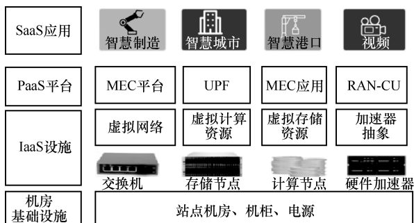
图2 边缘计算部署体系架构
